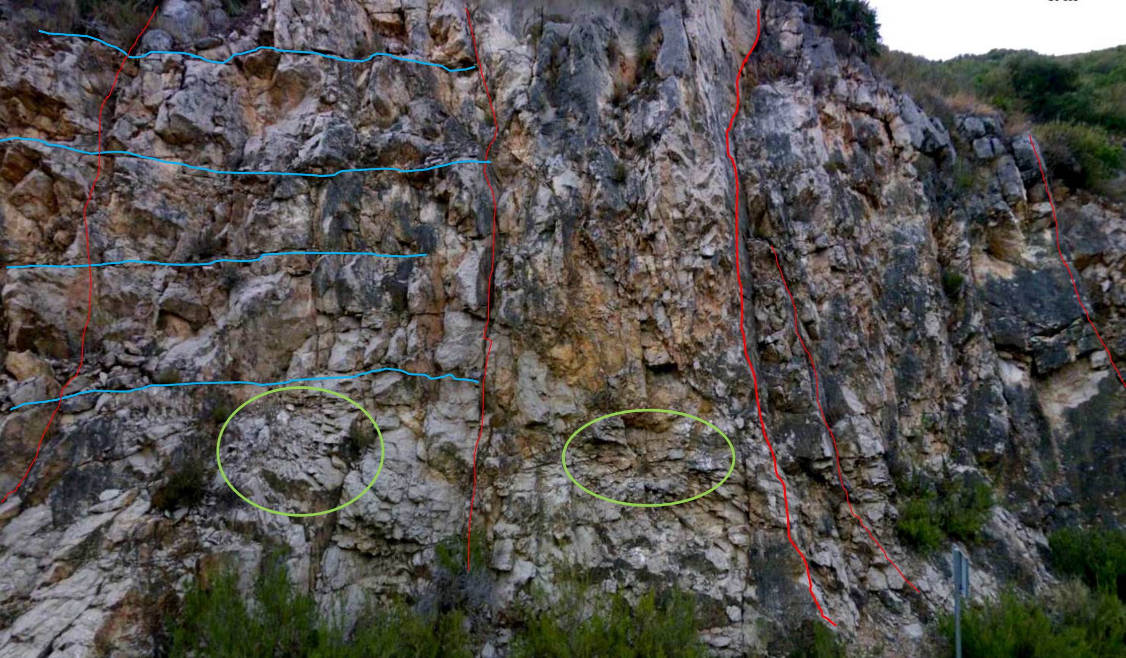
Familias de discontinuidades- por fallas, estratificación, diaclasado..- en las calizas pisolíticas del Kimmeridgiense, Malm, Jurásico. Al SW del Alto de La Bandera. NE Hoja de Chulilla
