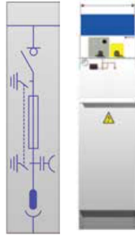
Figura 54. Celda modular de protección con fusibles con aislamiento en gas SF6.
