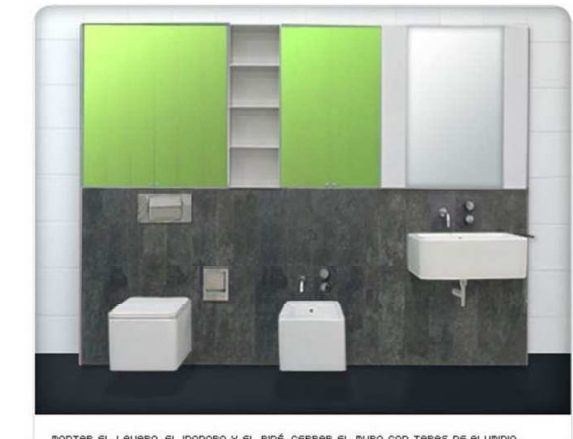
BONTAR EL LAVABO, EL INODORO Y EL BIDÉ. CERRAR EL MURO CON TAPAS DE ALUMINIO.
