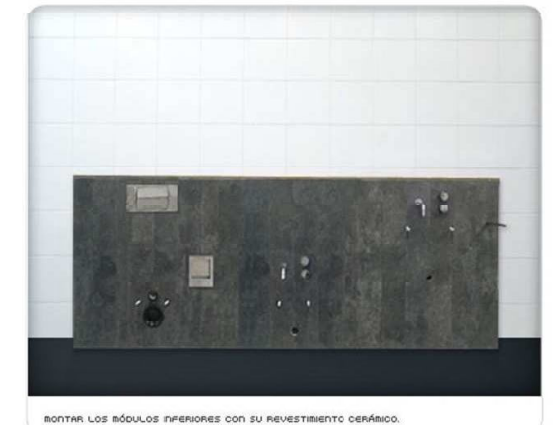
BONTAR LOS MÓDULOS INFERIORES CON SU REVESTIMIENTO CERÁMICO.
