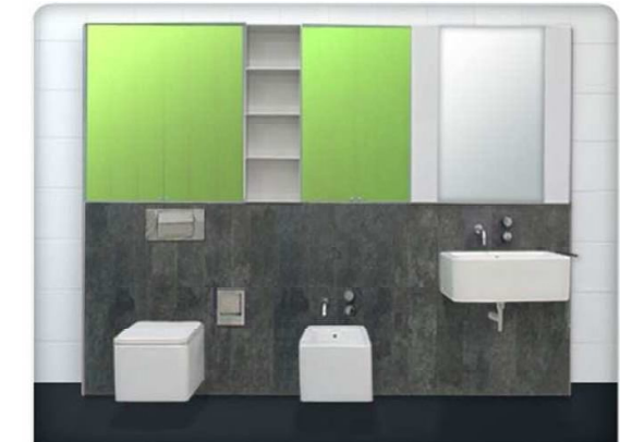
BONTAR EL LAVABO, EL INODORO Y EL BIDÉ. CERRAR EL MURO CON TAPAS DE ALUMINIO.
