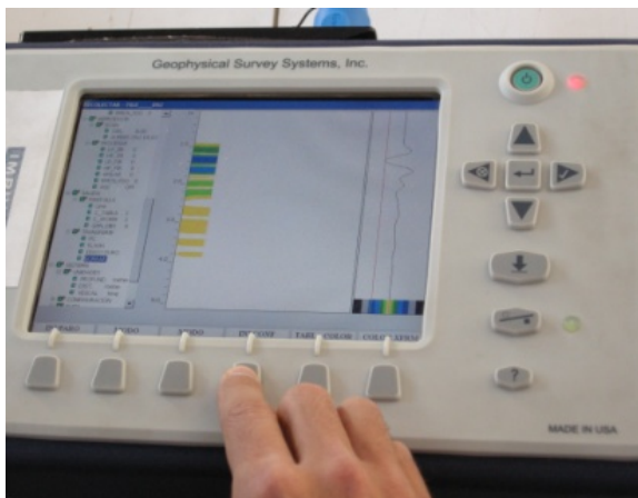
Fig. 10: Imagen del display del SIR 3000 (izq.) y de la antena Palm 2000 MHz (dcha.)
