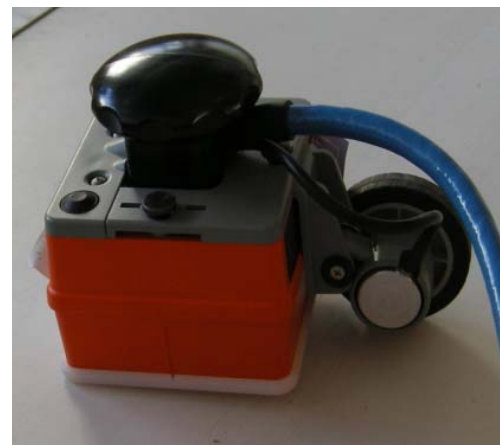
Fig. 10: Imagen del display del SIR 3000 (izq.) y de la antena Palm 2000 MHz (dcha.)
