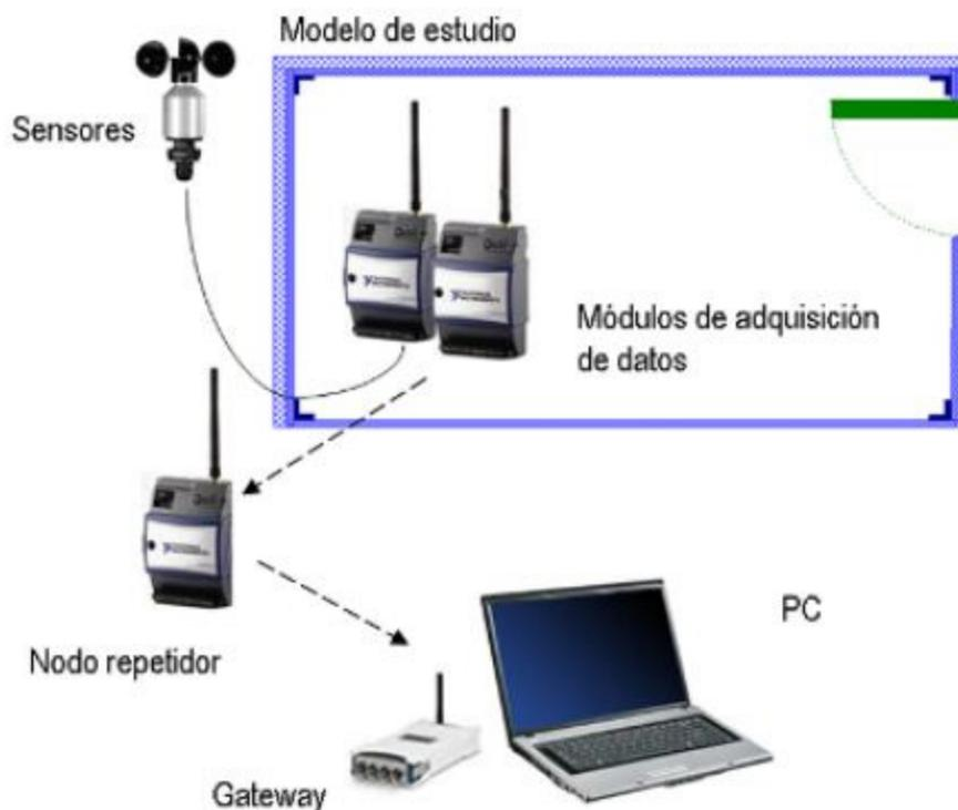
Figura 4.19 Protocolo ZigBee
