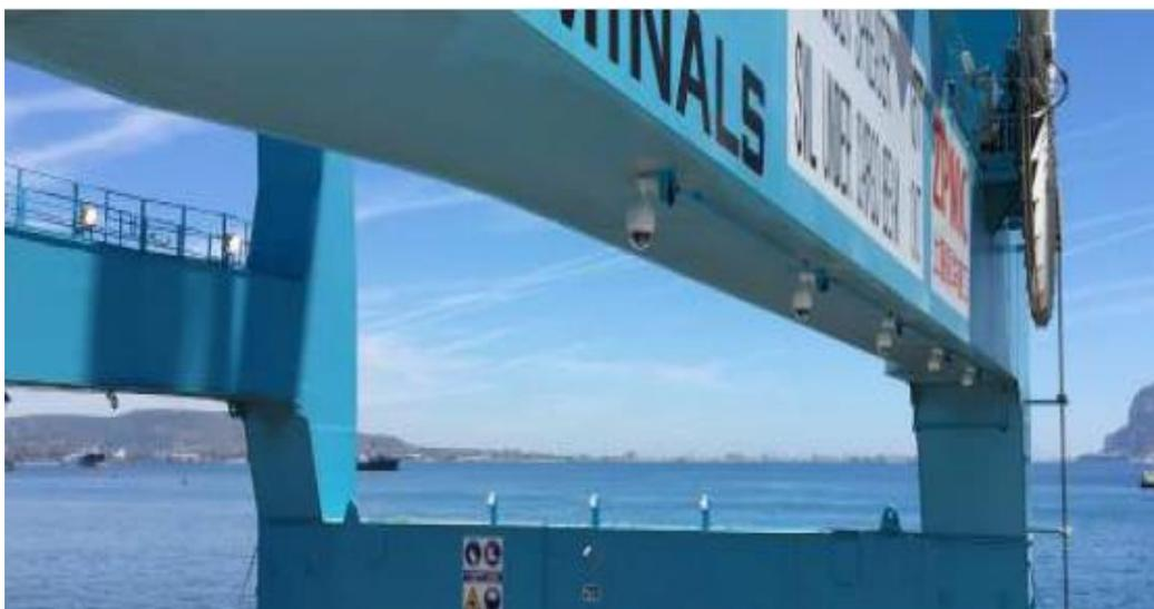
**ILUSTRACIÓN 44 SISTEMA DE RECONOCIMIENTO DE CONTENEDORES EN LA GRÚA MUELLE. FUENTE. TERMINALES AUTOMATIZADAS Y SEMIAUTOMATIZADAS. FUNCIONAMIENTO Y EQUIPOS. UPC**
