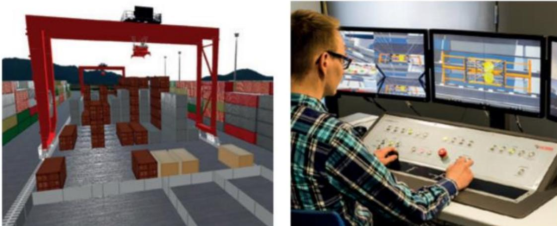
ILUSTRACIÓN 52 CONTROL REMOTO DE LAS GRÚAS ASC KARLMAR. FUENTE: KALMAR
