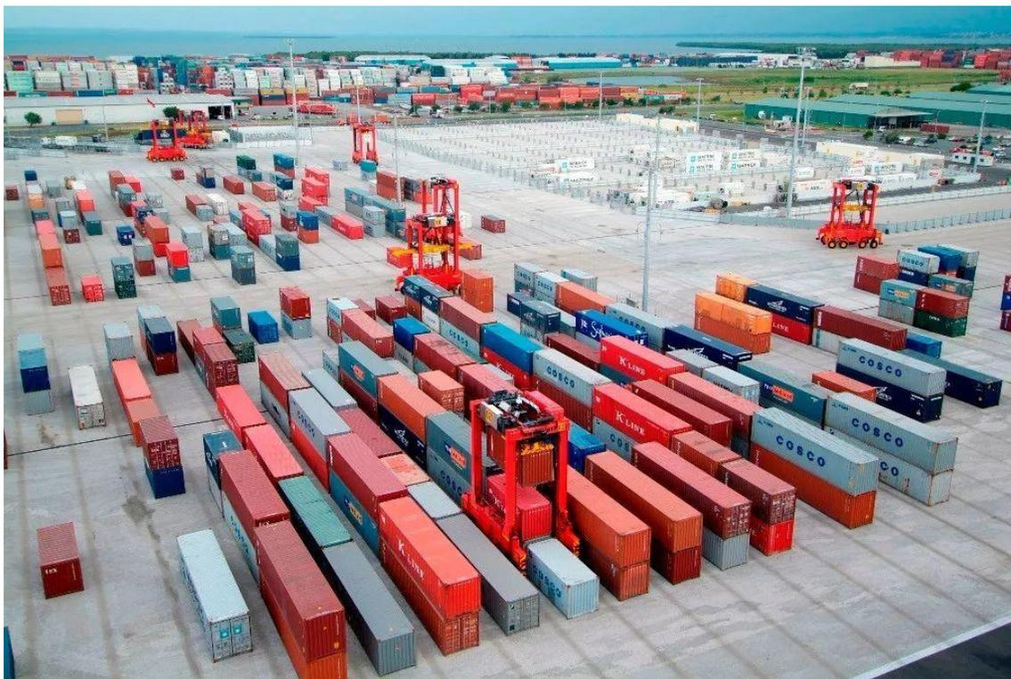
ILUSTRACIÓN 36 TERMINAL OPERADA CON AUTOSTRAD. FUENTE: SOHU.COM
