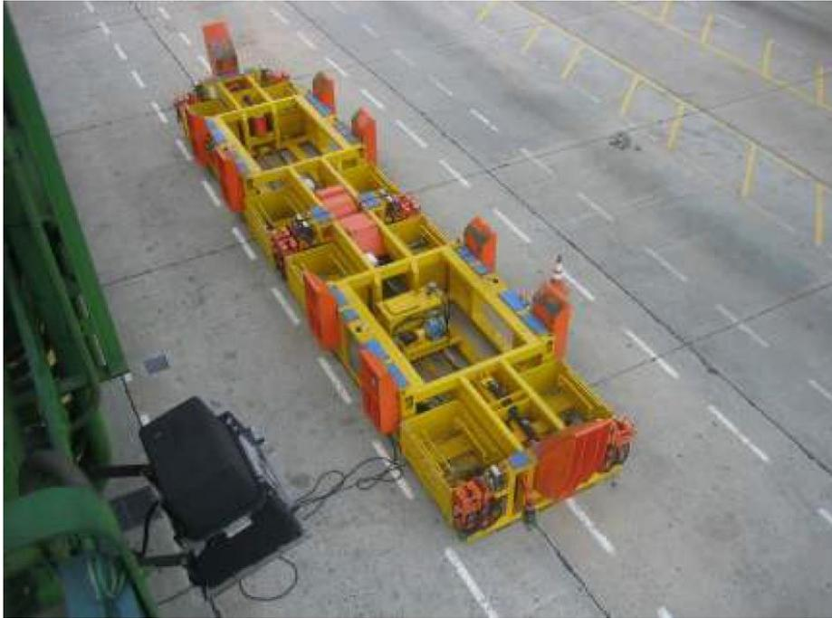
ILUSTRACIÓN 43 PLATAFORMA DE COLOCACIÓN DE TWIST-LOCKS AUTOMÁTICA.
