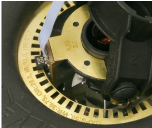
Figura 3.5: Detall d'un encoder muntat sobre una roda.
