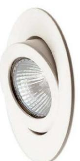
Se trata de una mini downlight para empotrar en el techo, basculante, con lámpara QR-CB51 G5,3 máx. 35 W-12V. Con cuerpo de aluminio. Ø66 mm. Emplearemos los mini spotlight en los auditorios, empotrados en el falso techo y la concha. Se reforzará la zona del escenario con proyectores. También se podrá usar en los espacios cerrados que ya posean una iluminación principal, para acabar de complementarla.
