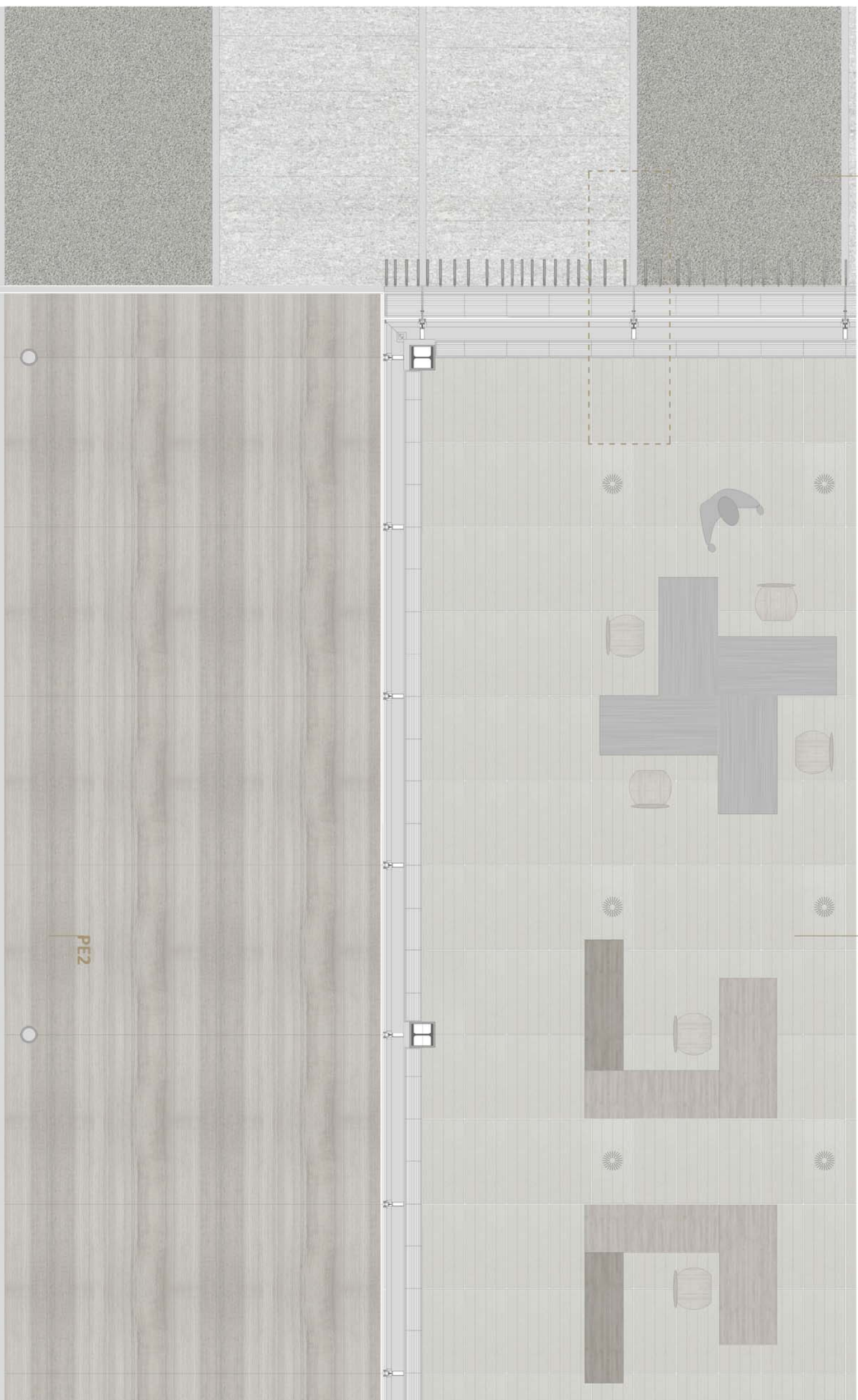
PT1 Suelo técnico registrable mediante baldosa sólida inerte F-X-PE. (Eide) de gres porcelánico 100 x 50 mm
