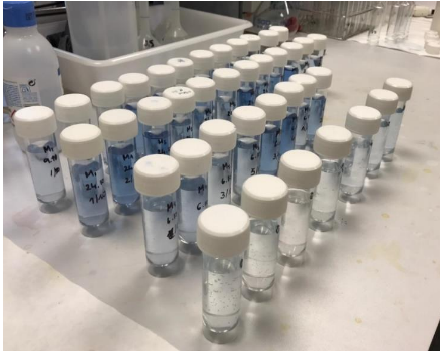
Figura 12. Determinación de Si. En vez de tubos de ensayo convencionales, se usan tubos de policarbonato para evitar interferencias con el borosilicato. (Imagen de elaboración propia).
