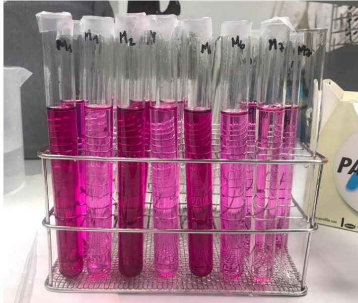
Figura 11. Determinación de nitritos. Nótese la diferencia de intensidad del color en función de las concentraciones: a mayor intensidad, mayor concentración. (Imagen de elaboración propia).
