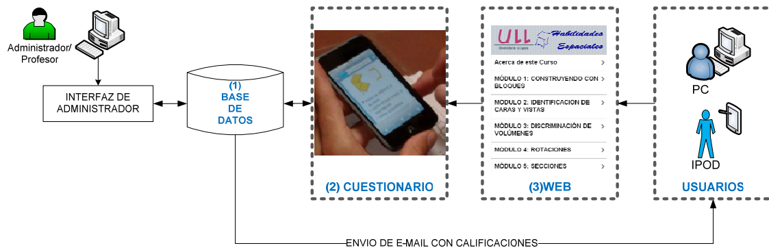
Figura 36.- Arquitectura del sistema
