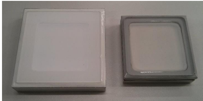
Figura 41. Cristales centelleadores de volumen activo 25.8 \times 25.8 \times 5 \text{ mm}^3 . Izquierda: \text{LaBr}_3 de Saint-Gobain Crystals. Derecha: \text{CeBr}_3 de Hellma Materials.
