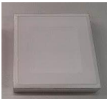
Figura 27. Cristal de \text{LaBr}_3 fabricado por Saint-Gobain Crystals con un volumen activo de 25.8 \times 25.8 \times 5 \text{ mm}^3 .
