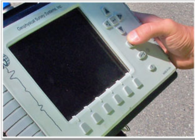
Figura 9. Unidad SIR 3000 de GSSI con equipo de visualización integrado. (www.geophysical.com)
