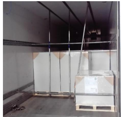
Ilustración 19. Mercancía inmovilizada por barras en el interior del camión. Elaboración propia.
