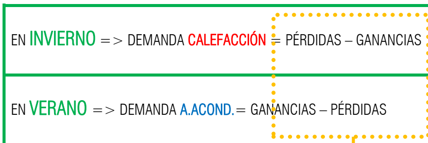
Función del aislamiento térmico
