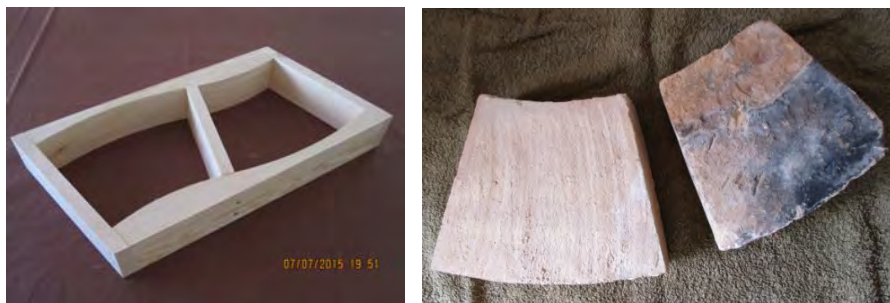
Figura 4.4 y 4.5: Gradilla y nuevo ladrillo aplantillado, junto a otro original.
