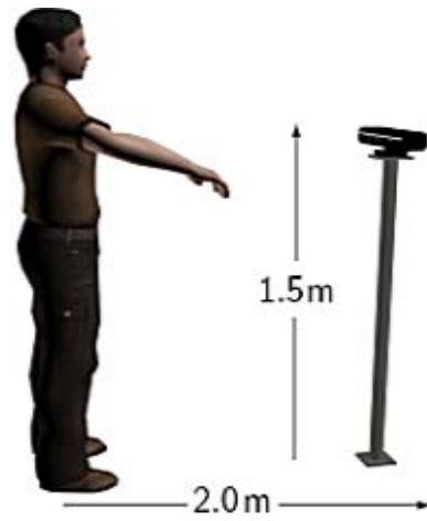
Figura 6: Colocación del sensor
