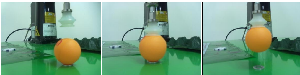
Figura 21: Detalle del proceso de succión de la bola
