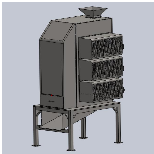
Figura 86: Montaje de las cajas de protección de los sistemas de transmisión
