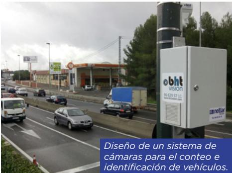
Diseño de un sistema de cámaras para el conteo e identificación de vehículos.
