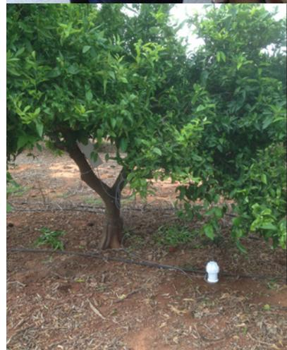
Sonda de humedad para controlar la eficiencia del riego.
