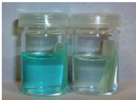
Figura 5.12 Fotografía de las tiras reactivas (1 x 2 cm) sumergidas en una disolución de escuaridina ( 2.6 \times 10^{-6} M) en acetonitrilo. La tira sumergida en el vial de la izquierda fue previamente expuesta a aire que contenía una concentración de DFP de 5 ppm. La tira sumergida en el vial de la derecha fue sumergida directamente en la disolución de escuaridina.
