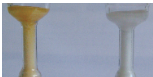
Figura 2.22 Izquierda: tubo de vidrio con el reactivo cromogénico R1 adsorbido sobre sílice. Derecha: silica gel con el reactivo cromogénico R1 adsorbido después de haber pasado 1 mL de una disolución de DCP en acetonitrilo ( 1.0 \times 10^{-3} \text{ mol dm}^{-3} ).
