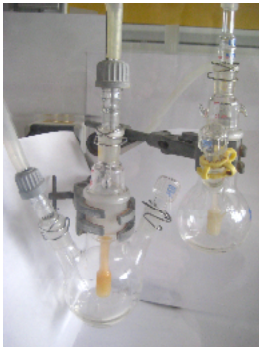
Figura 2.23 Izquierda: tubo de vidrio con el reactivo cromogénico R1 adsorbido sobre sílice. Derecha: sílica gel con el reactivo cromogénico R1 adsorbido después de haber pasado 1 litro de aire con una concentración de DCP de 5 ppm
