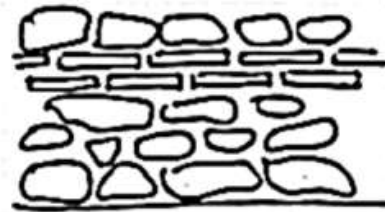
Figura 19. Verdugada. Fuente: elaboración propia
