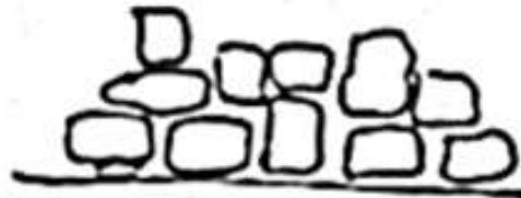
Figura 6. Mampuesto a tizón. Fuente: elaboración propia
