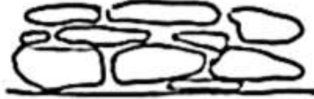
Figura 4. Mampuesto a hueso. Fuente: elaboración propia
