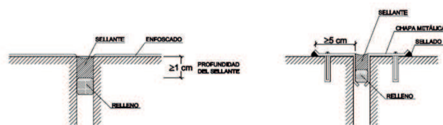
Figura 2.6 Ejemplos de juntas de dilatación
