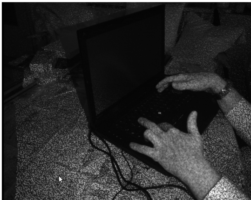
Figura 17: Imagen del patrón infrarrojo proyectado por Kinect
