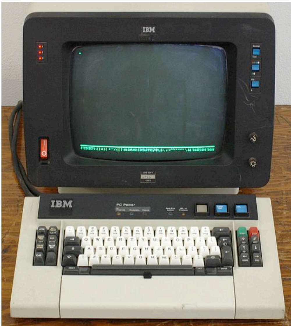
Figura 1: IBM 3279. Terminal utilizada para comunicarse con mainframes IBM. Fuente: http://en.wikipedia.org
