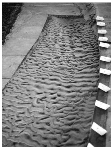
Figura 3. Ensayo sin protección – Estado final del lecho erosionado
