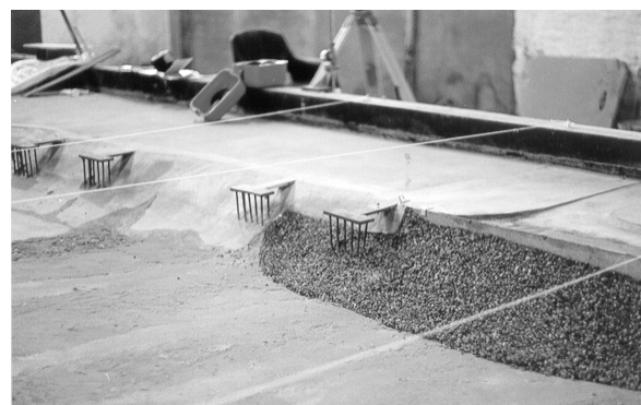
Figura 5. Ensayo con protección (Coraza)
