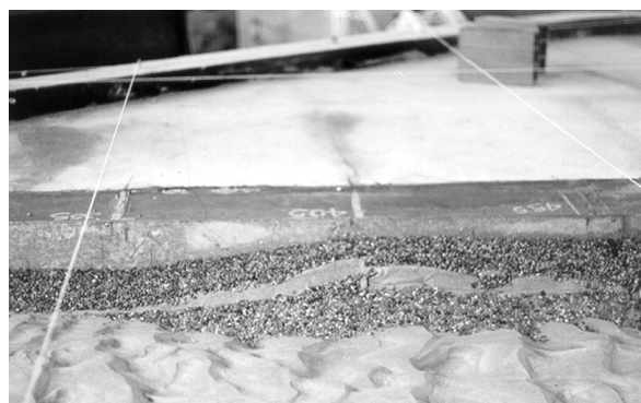
Figura 10. Aspecto del estado final de la protección con el lecho erosionado
