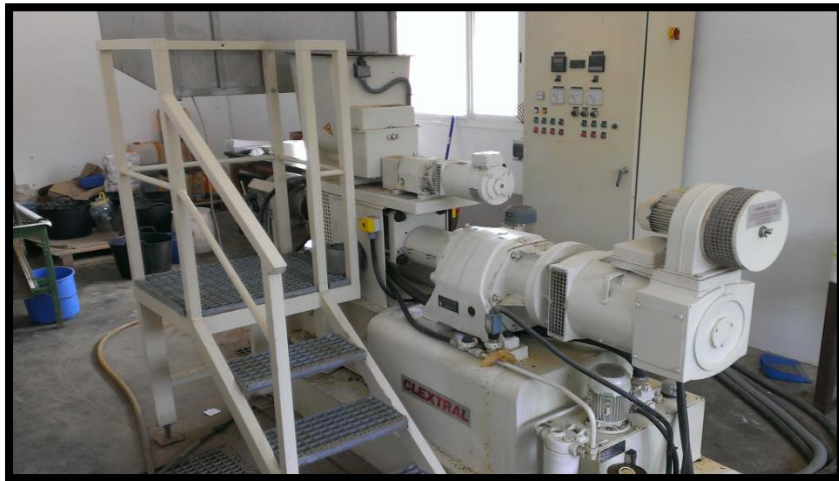
Figura 5 : Extruder semi-industrial, modelo BC45 del Departamento de Ciencia Animal de la UPV. Fuente: Imagen propia.
