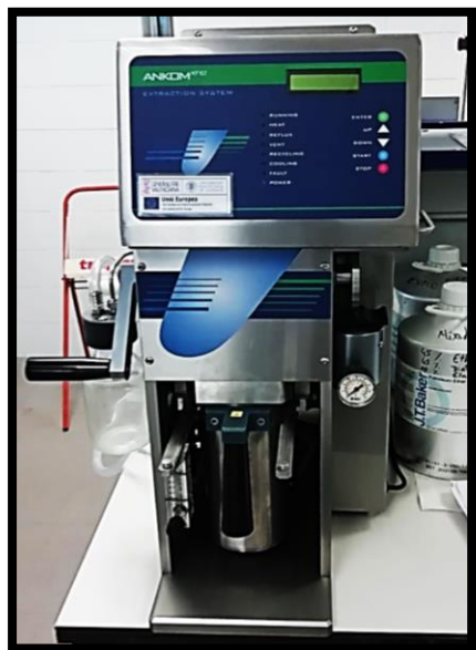
Figura 9 Extractor de grasa ANKOM XT10 Fuente: Imagen propia
