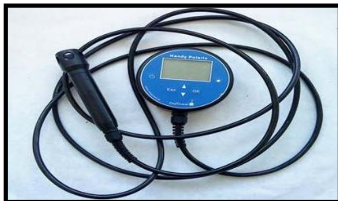
Figura 3. Oxímetro portátil o sonda (OxyGuard Handy Polaris). Fuente Imagen propia
