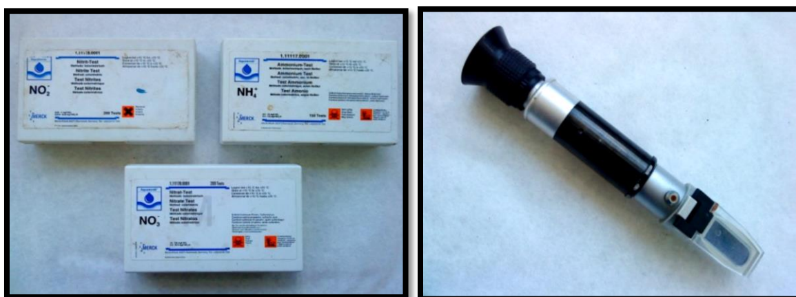
Figura 4 Test colorímetro para concentración de amonio, nitratos y nitritos (MERCK) (izda) Refractómetro (HannaInstruments)(dcha) Fuente: Imagen propia
