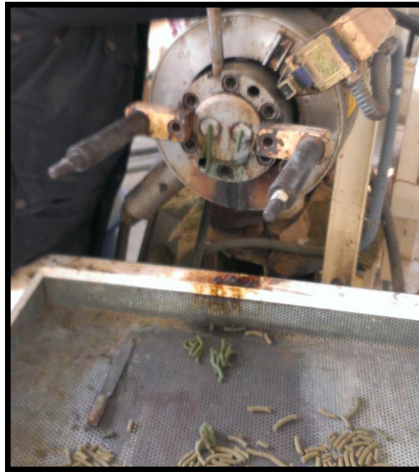
Figura 6: Detalle de la boquilla del Extruder y pienso producido.
