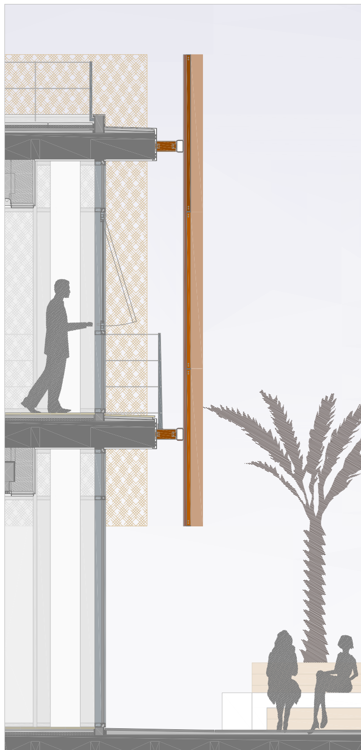
SECCIÓN POR DOBLE FACHADA
