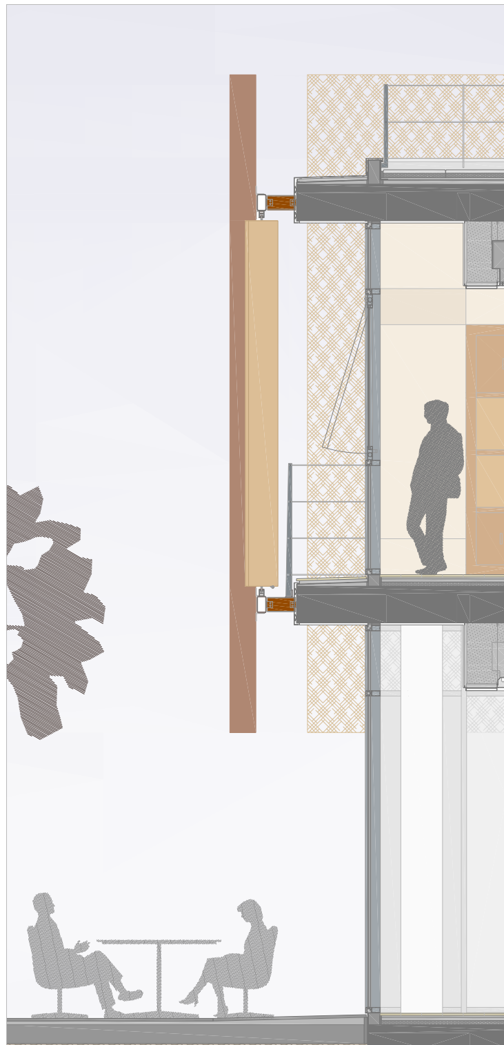
SECCIÓN POR DOBLE FACHADA
