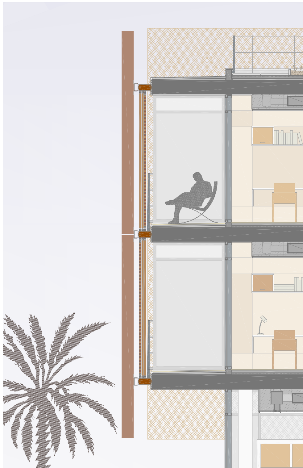
SECCIÓN POR DOBLE FACHADA
