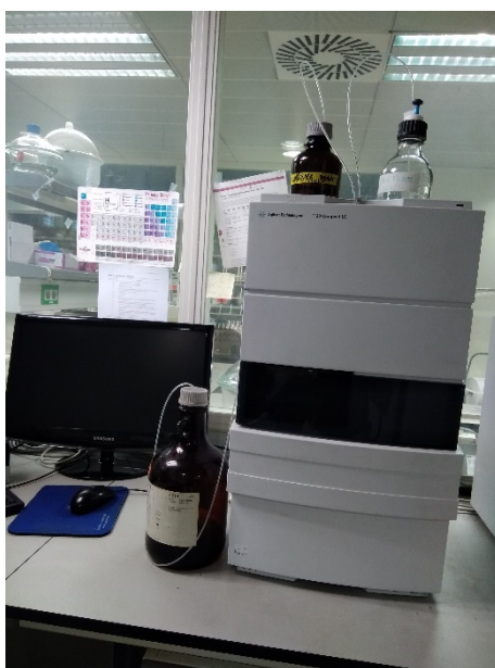
Figura 3.6. Cromatógrafo HPLC con detector ultravioleta (UV)
