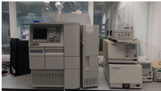
Figura 3.12. Cromatógrafo HPLC con detector de matriz de fotodiodos.
