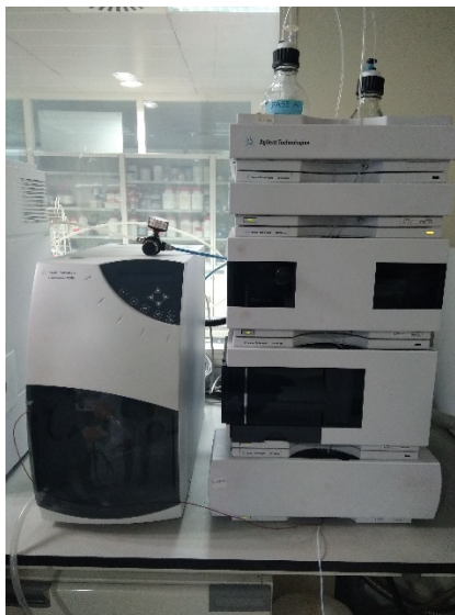
Figura 3.9. Cromatógrafo HPLC con detector de dispersión de luz evaporativa (ELSD).
