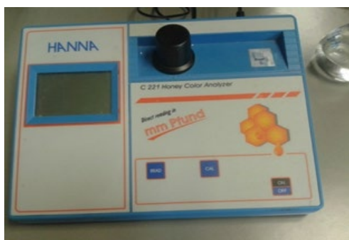
Figura 3.7. Colorímetro diseñado específicamente para la miel.
