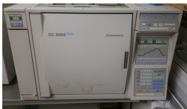
Figura 3.14. Cromatógrafo de gases con detector de ionización de llama (FID).
