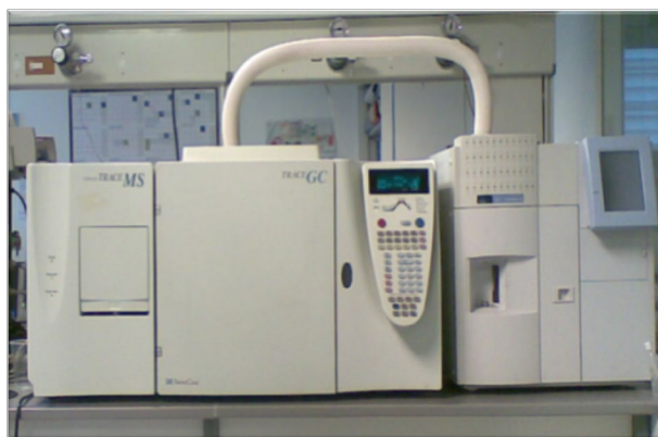
Figura 3.11. Desorbedor térmico acoplado a un cromatógrafo de gases con detector de masas.
