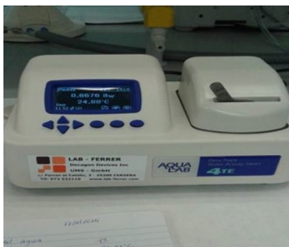
Figura 3.3. Higrómetro de punto de rocío.
