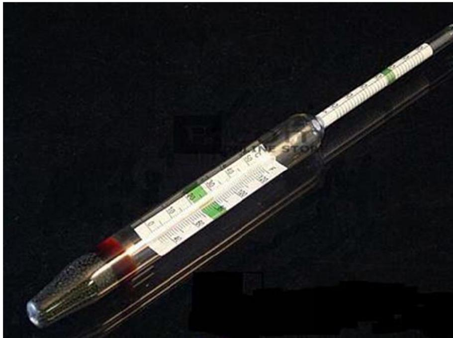
Fotografía 2.3.3.7.2. Densímetro ASTM 152H
