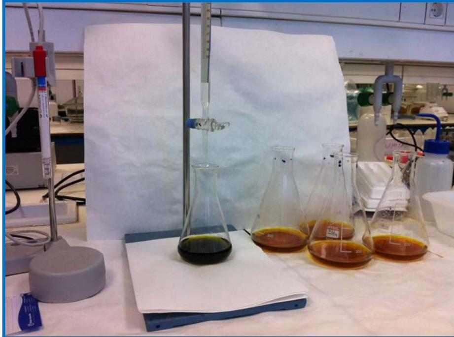
Fotografía 2.3.2.6.1 Valoración del sulfato ferroso.
