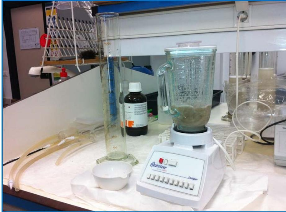
Fotografía 2.3.3.6.1 Muestra en vaso dispersador de batidora.
