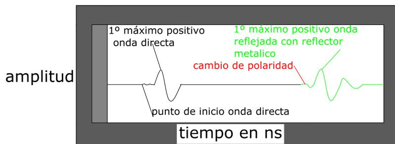
figura 42 cambio de polaridad en la reflexión
