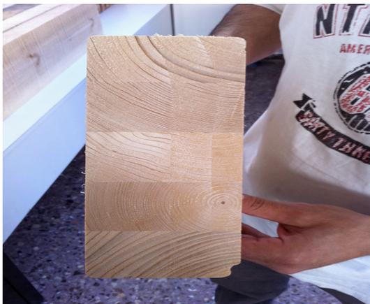
figura 19 a foto de viga laminada
