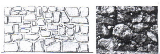
Fig. 4.21- Mampostería ordinaria. Obtenidas del libro BLAT, JV. Construcción .
