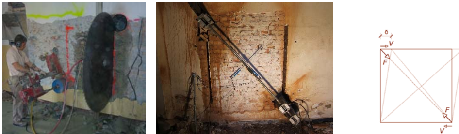
Figura 7: Determinación de la resistencia a cizallamiento [7]
