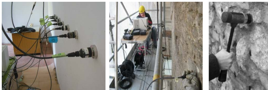
Figura 1. Sensores y martillo en una prueba sónica [7]
