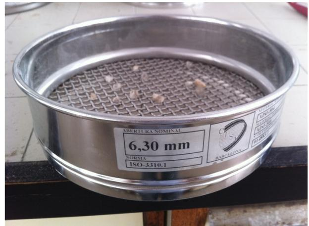
*Figura 3.2.4.y 3.2.5. Resultado del tamizado con tamices de 8mm y 6,3mm, respectivamente.*
