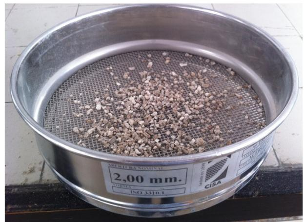
*Figura 3.2.6.y 3.2.7. Resultado del tamizado con tamices de 2mm y 4mm, respectivamente.*
