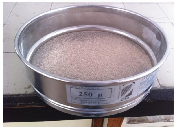
*Figuras 3.2.10. y 3.2.11. Resultado del tamizado con tamices de 125 $\mu$  y 250 $\mu$ , respectivamente.*
