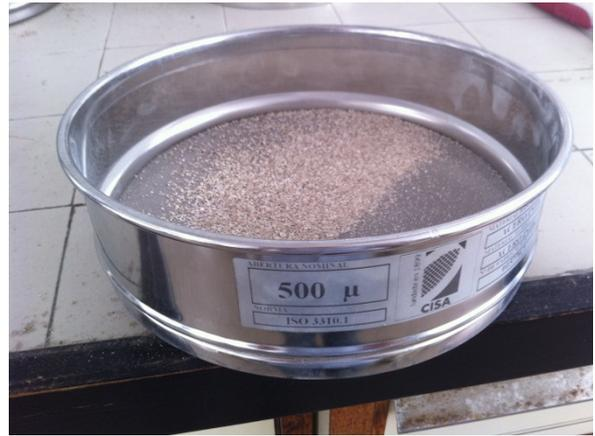
*Figura 3.2.8.y 3.2.9. Resultado del tamizado con tamices de 1mm y 500 $\mu$ , respectivamente.*
