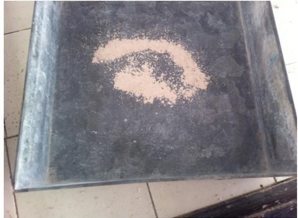
*Figuras 3.2.12. y 3.2.13. Resultado del tamizado con tamices de  $63\mu$  y muestra  $< 63\mu$ , respectivamente.*
