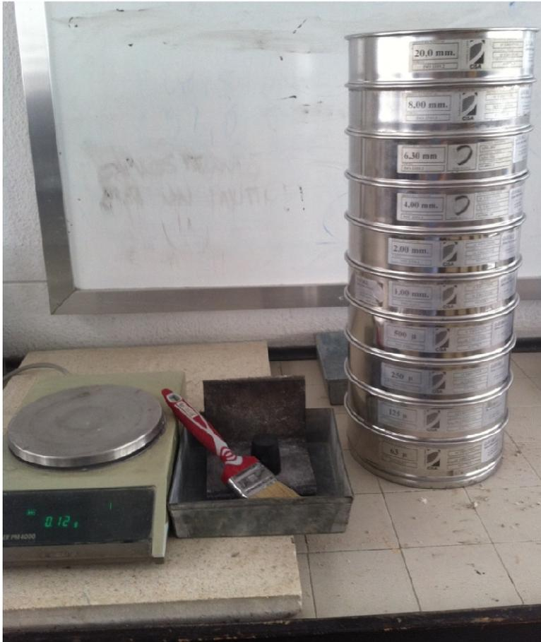
*Figura 3.2.1. Utensilios empleados en el ensayo de granulometría*
