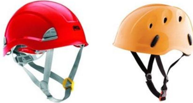
Exigencias obligatorias: Absorción del impacto, resistencia a la perforación y resistencia a la llama. Además, los puntos de anclaje del barboquejo deben garantizar una rotura o fallo a partir de una fuerza de tracción equivalente a los 15 Kg, con el fin de evitar daños en la mandíbula o cuello si se quedan enganchados del barboquejo.
