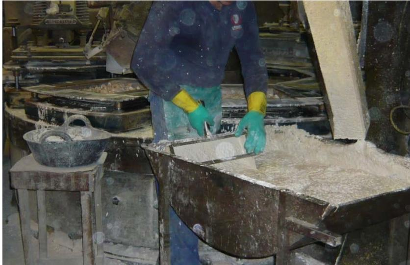
**Imagen 4: Sistema de fabricación de baldosas de terrazo**
