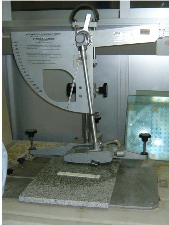
**Imagen 9: Péndulo empleado en los ensayos de resbaladidad**
