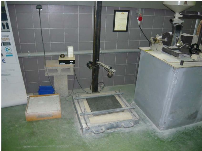
**Imagen 11: Máquina de ensayo de resistencia al impacto**
