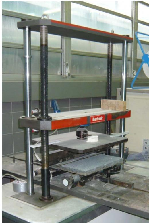
**Imagen 6: Ejemplo real de un ensayo de flexocompresión**
