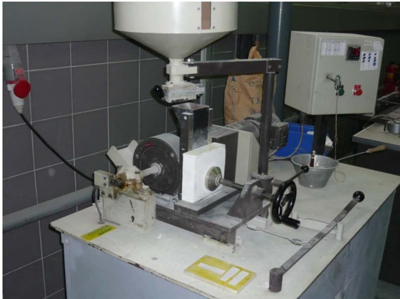
**Imagen 7: Máquina de disco ancho**
