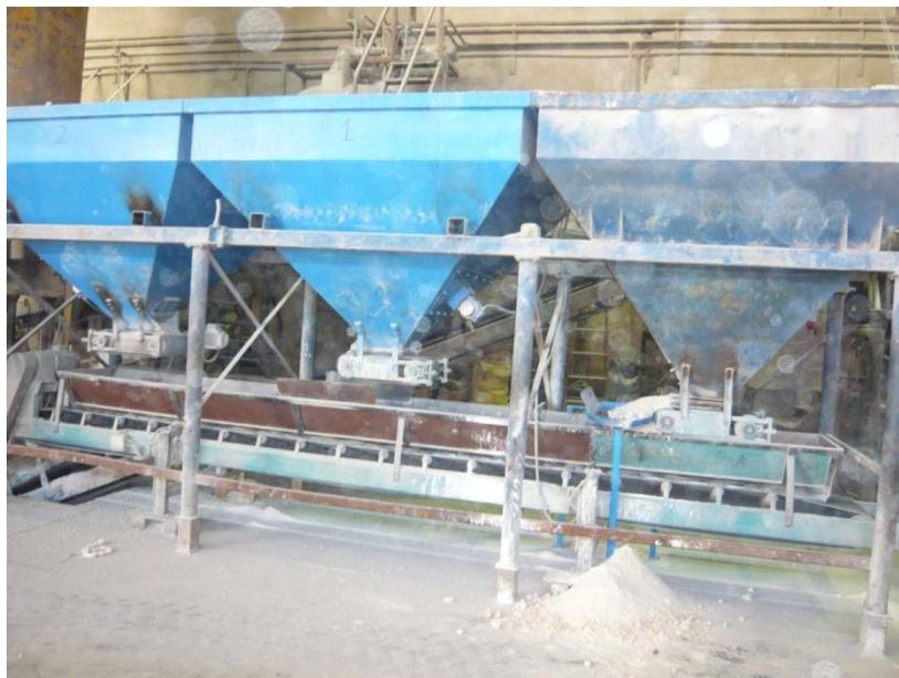
**Imagen 3: Dosificación de mortero para fabricación de baldosas**
