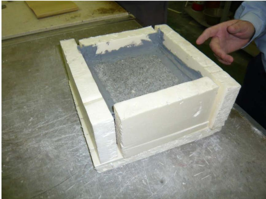
Imagen 10: Ejemplo de muestra para ensayo con sales descongelantes
