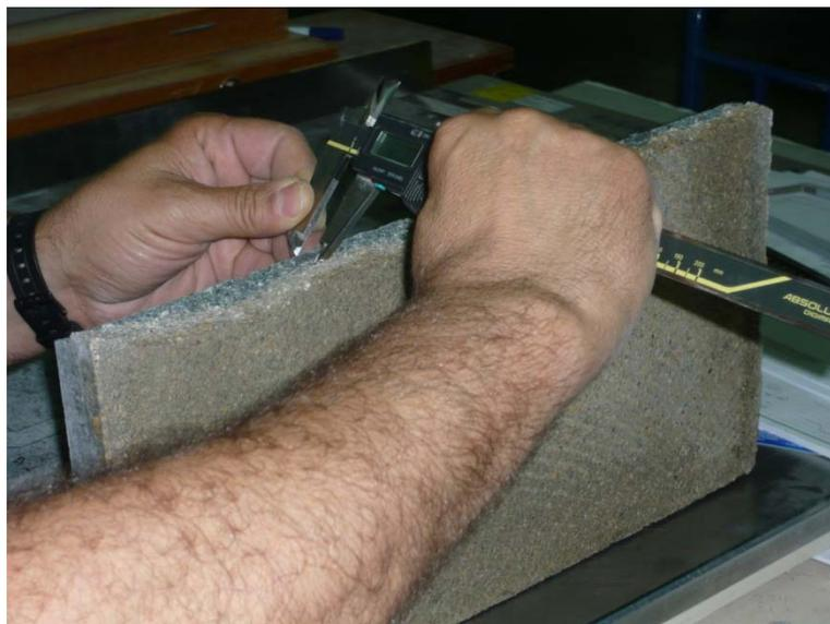
**Imagen 6: Ejemplo real de comprobación dimensional de la baldosa**
