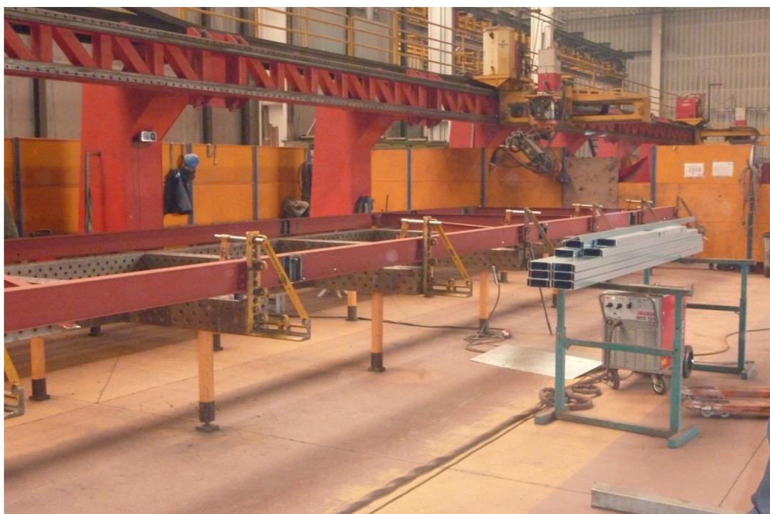
*Mesa de replanteo y corte de perfiles para montaje de estructura pórticos y jácenas específica para este tipo de modulación.*
