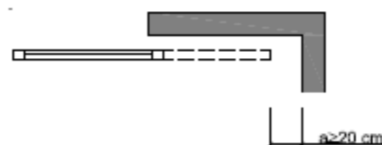
Figura 2.1 Holgura para evitar atrapamientos
