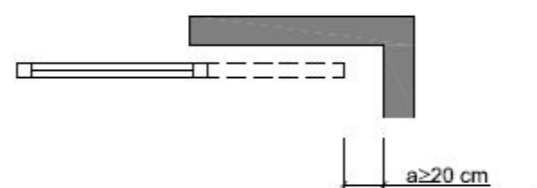
Figura 2.1 Holgura para evitar atrapamientos
