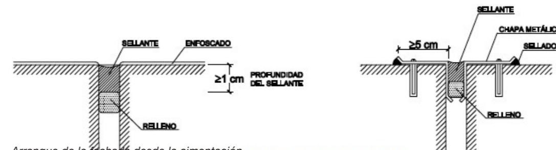
Figura 2.6 Fijación de juntas de dilatación
