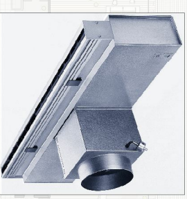
Difusor de ranura "Trox" VSD35. La ranura està formada per un perfil d'alumini estructurat sense marc perimetral. Utilitzat en espais que no superen els 4 metres d'altura.
