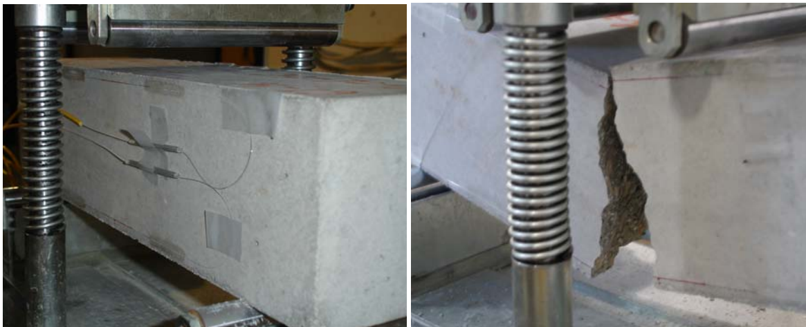
Fig.14. Imagen de los ensayos a flexotracción sobre probetas de hormigón.
