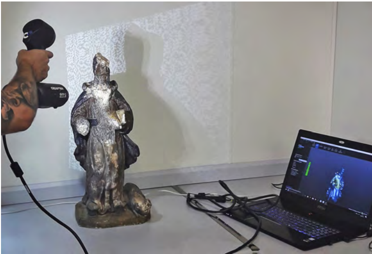
Figura 1. Fase de registro 3D de la escultura San Antonio Abad mediante escáner Go!SCAN50, de la empresa Creafom. Obsérvese la visualización digital del proceso de escaneado en tiempo real.
