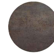
8 portón y escalera tubo con piel de acero corten iron-moss de 3mm
