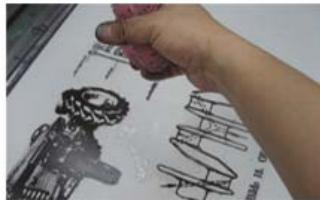
humedeciendo la placa con agua
