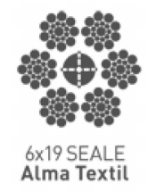
Imagen y detalle del cable para la nave, de 6 x 19 con alma textil de 7 x 7
