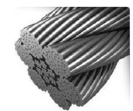
Imagen y detalle del cable para la nave, de 6 x 19 con alma textil de 7 x 7
