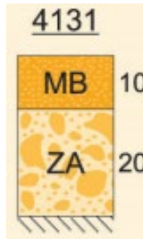
Figura 43. Paquete de firme seleccionado
