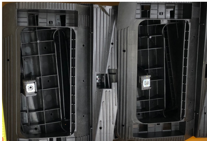
Figura 1. Grapa metálica insertada en un panel de puerta plástico.
