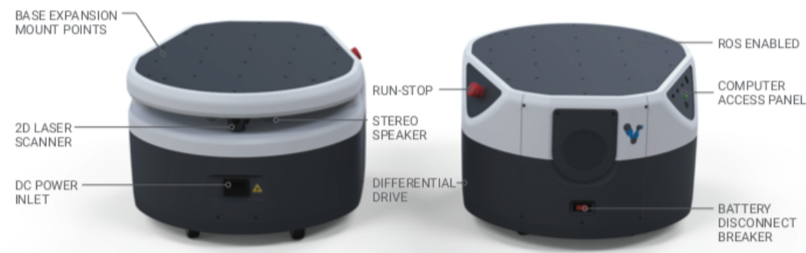
Figura 29. Base móvil del FETCH MOBILE MANIPULATOR. Recuperado de fetchrobotics.com .
