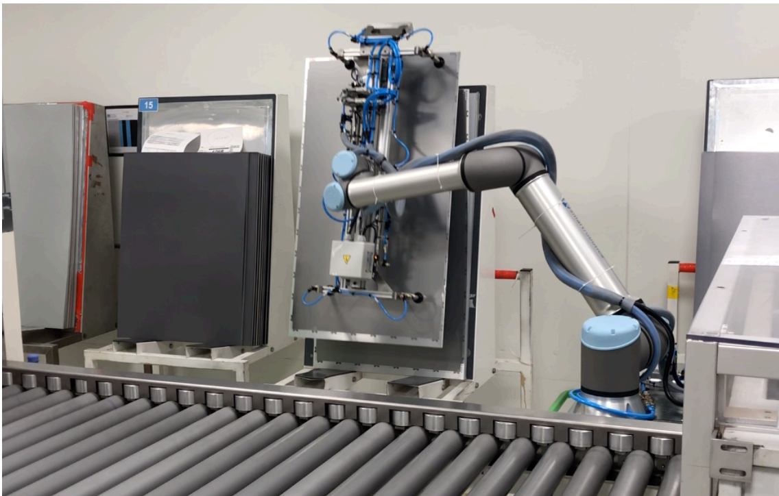
Figura 99. Perspectiva del robot realizando cogida de pieza.
