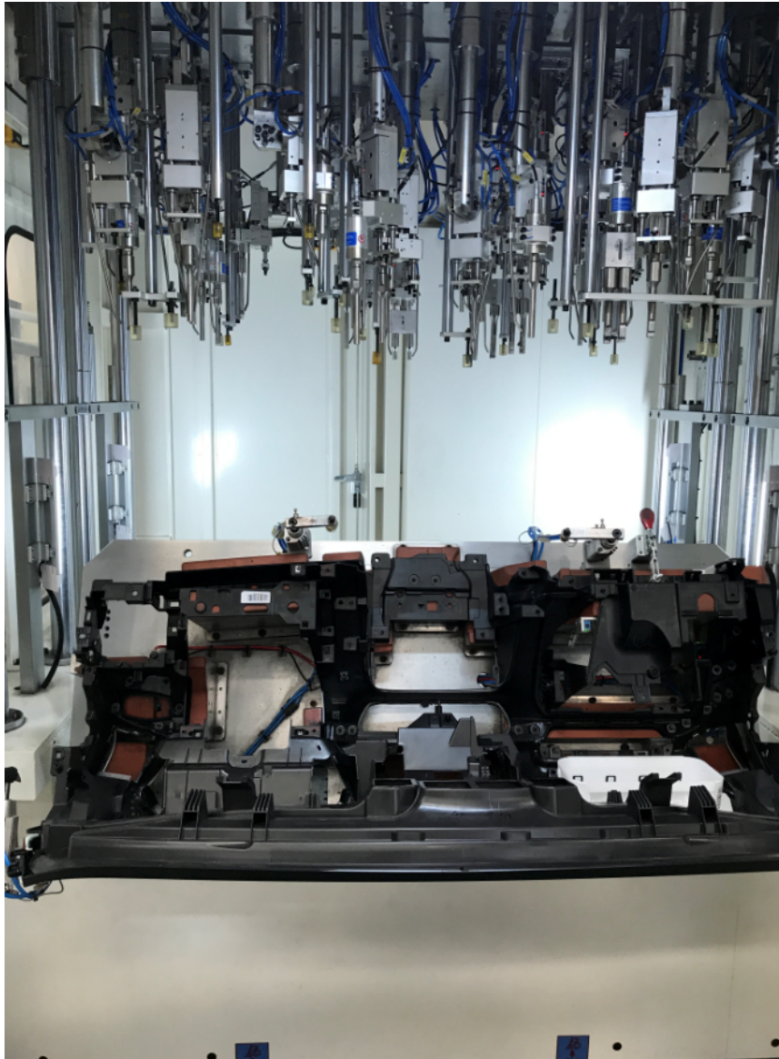
Figura 6. Máquina de soldadura automática con carga manual.
