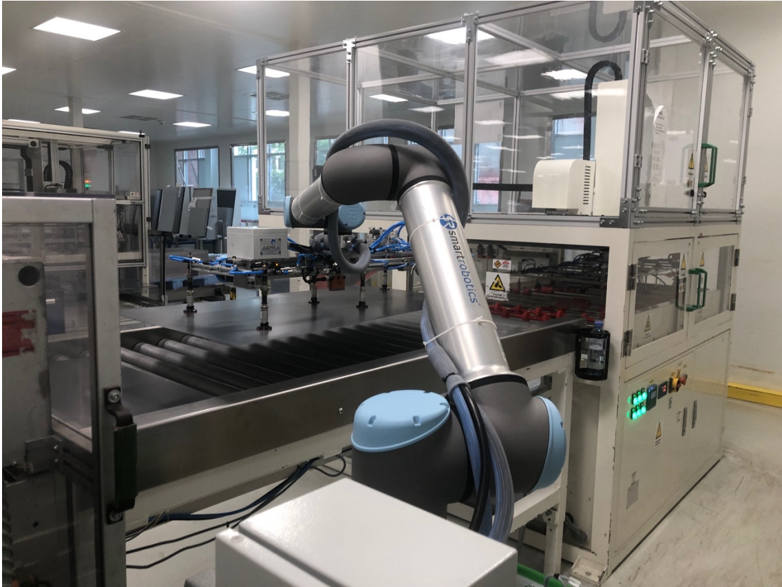
Figura 98. Robot realizando acción de dejar pieza sobre el transportador.
