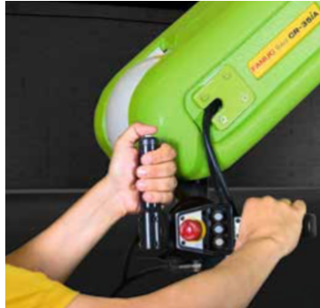
Figura 12. Sistema de movimiento manual para programación de FANUC. Recuperado de www.fanuc.eu .
