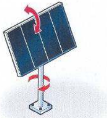
Figura 43: Seguidor solar móvil a dos ejes. Fuente: Turrillas (2014).
