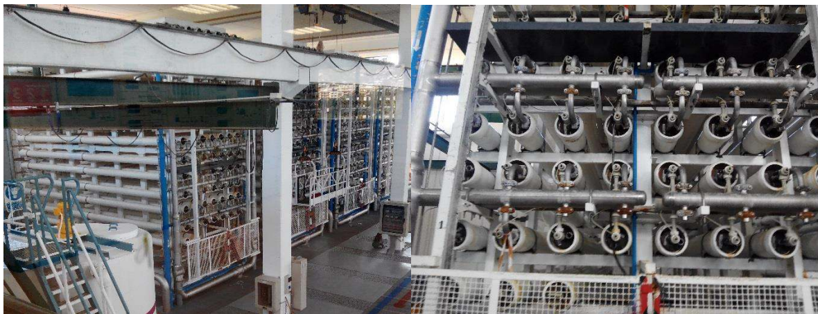
Figura 13: Bastidores de tubos de presión. Tubos de presión conectados en paralelo.
