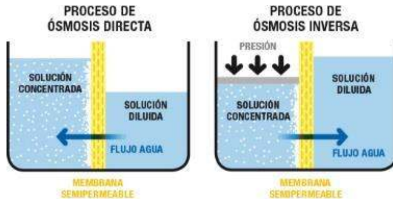
Figura 5: Procesos de ósmosis directa y ósmosis inversa. Fuente: ath (s.a.).
