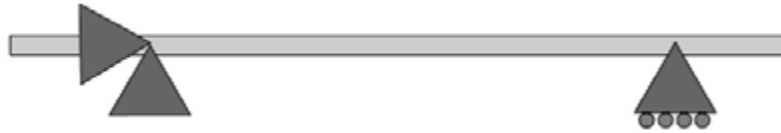
Figura 2.2.2: Extremos fijo y libre en un eje
