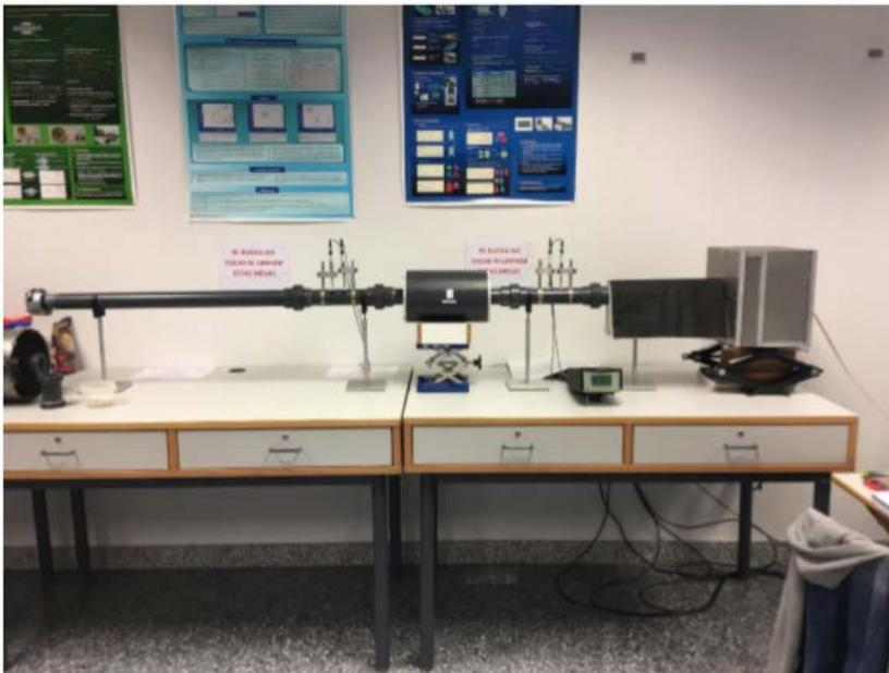
*Figura 90. Banco de ensayos empleado para la obtención del  $TL$  de las geometrías  $G1$  y  $G3$ .*
