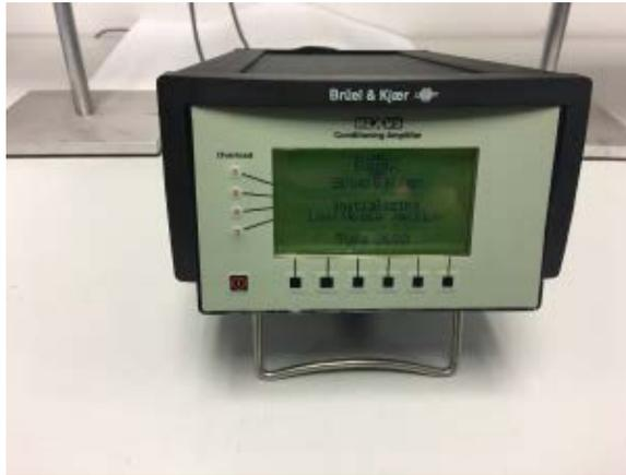
*Figura 95. Amplificador-acondicionador Nexus 2690.*
