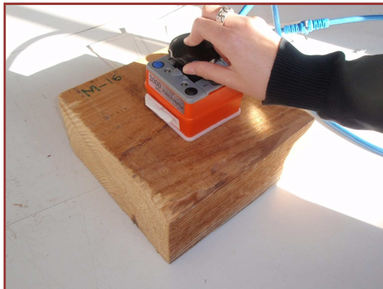
Figura 3.11. Ensayo estático con georradar..
