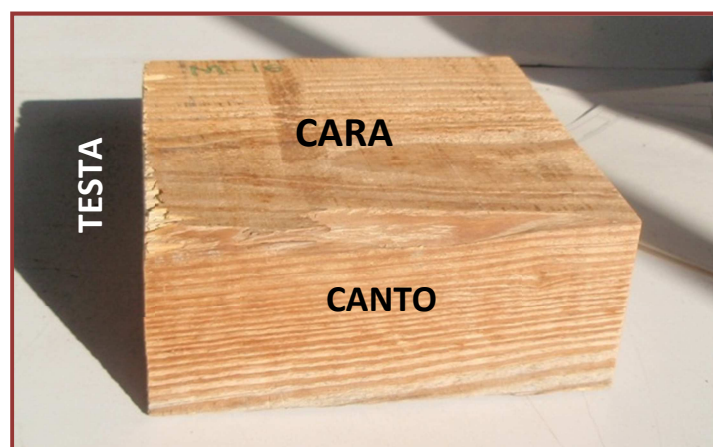
Figura 4.8. Designación de las superficies de una probeta.
