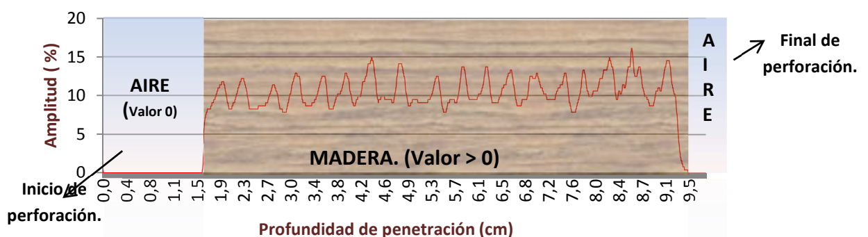
Figura 4.17. Valores del resistograma en función del medio atravesado.
